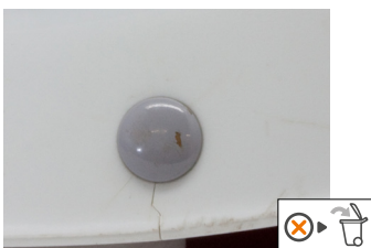
• Fissure sur la coque
