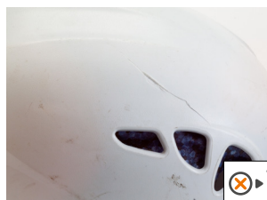
• Fissure sur la coque
