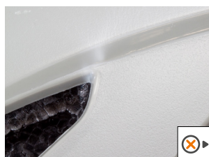
• Mousse de confort déchirée
