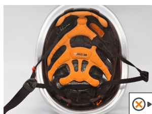
• Mousse de confort déchirée
