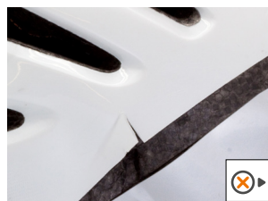
• Fissure sur la coque
