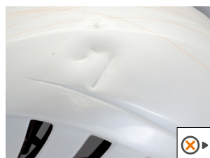
• Déformation de la coque
