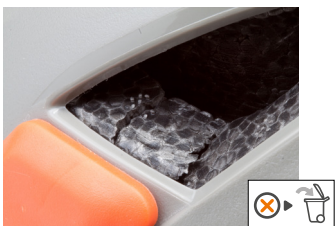
• Fissure sur la coque
