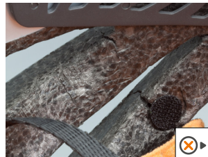
• Fissure sur la coque
